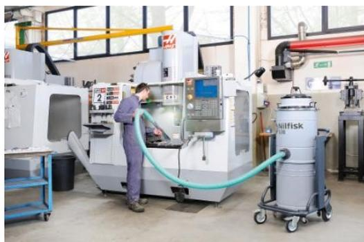
Fiabilidad, potencia y sencillez para esta aspiradora industrial diseñada para el sector mecánico, en particular para la recogida de virutas mezcladas con aceite.
